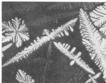
Abbild. 3. Spontane Kristallisation von Dendriten bei 275^\circ
